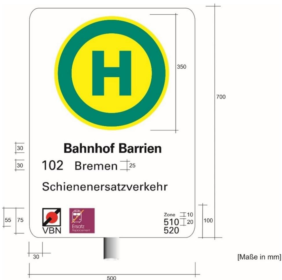
Abbildung 16: Haltestelle, die auch für Schienenersatzverkehr genutzt wird
