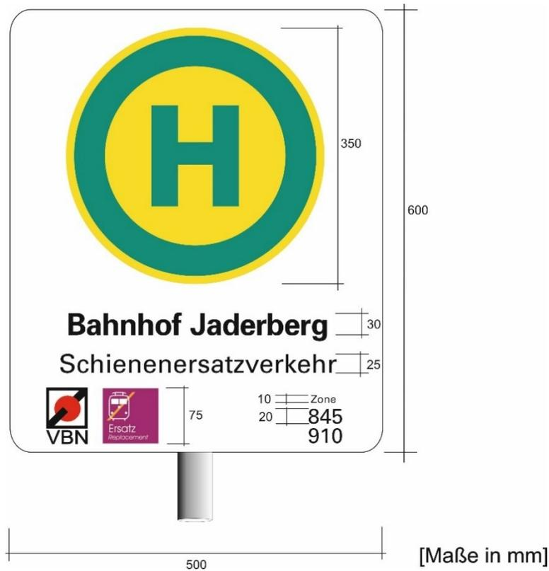
Abbildung 17: Haltestelle, die nur für Schienenersatzverkehr genutzt wird
