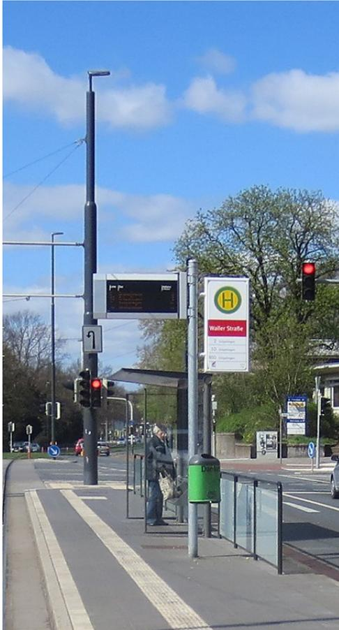
Abbildung 9: Kombimast mit Haltestellenschild und DFI
