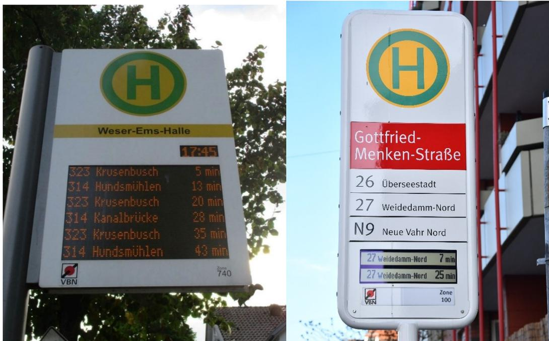
Abbildung 21: Haltestellenschilder mit integrierter dynamischer Fahrgastinformation
